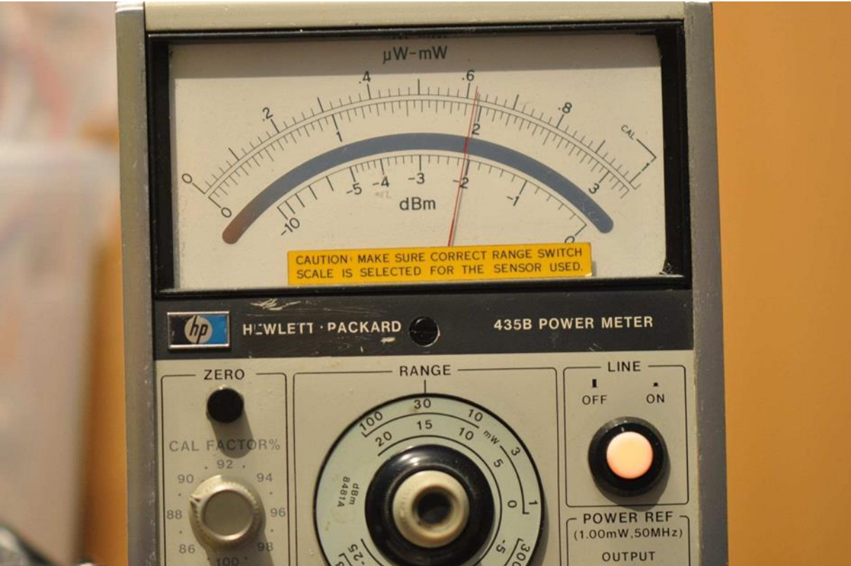
Измеренная мощность OSC на уровне 20мВт
